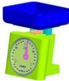
Funcionan según un mecanismo de precisión que ejerce cierta resistencia a la vez que marca sobre una escala graduada el peso a través de una aguja indicadora o mediante panel electrónico.
