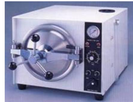
columnas de agua simétrica que equilibran la presión existente en la cámara. Comúnmente se utilizan para esterilizar materiales de vidrios, utensilios, también para neutralizar bacterias y otros microorganismos presentes en algunos medios de cultivo.
